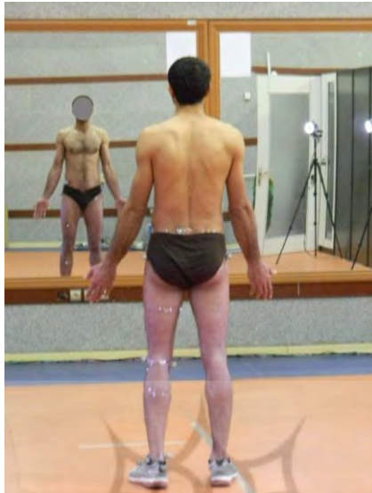
شکل ۱- مارکرگذاری بر روی پای چپ در حالت ایستا براساس مدل نشانه‌گذاری پلاگین گیت
