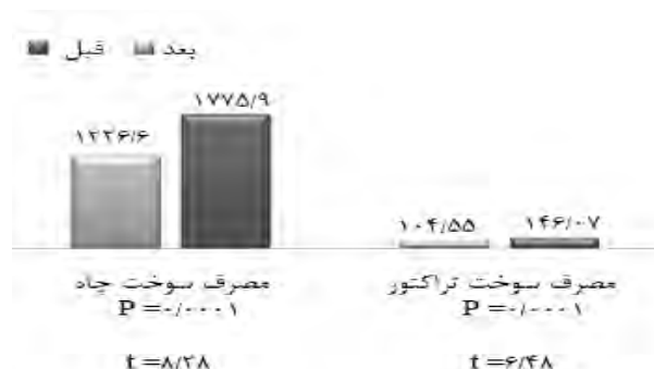
نگاره‌ی (۷) - مقایسه میانگین میزان مصرف سوخت تراکتور و پمپاژ آب از چاه قبل و بعد از اجرای تسطیح لیزری
