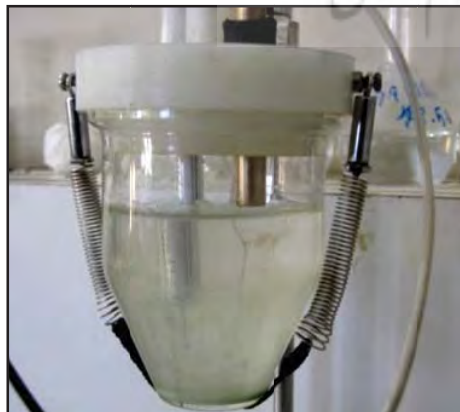
شکل (۲-۳): الکتروودهای برنزی تهیه شد به روش ریخته‌گری با درصد (Cu-10Sn)
