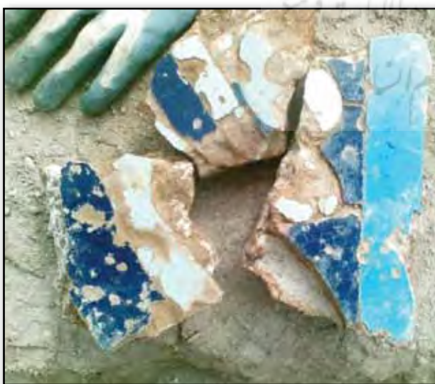
تصویر ۳. بقایای بخشی از کتیبه بنا به روش معرق که شامل خطوط فیروزه‌ای در بستر لاجوردی است. عکس: امین مرادی، ۱۳۹۱.
