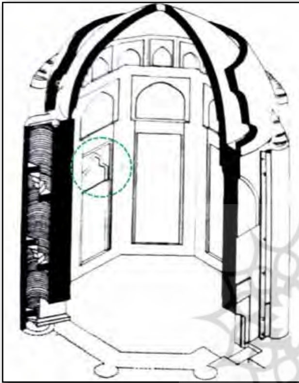
تصویر ۶ کاربرد نغول‌های تزئینی با زوایای شکسته در برج خرقان. مأخذ: پیرنیا، ۱۳۸۷. Fig. 6. Application of arch-faced decorations with an acute angle in Kharaqan Tower. Source: Pirnia, 2008.
