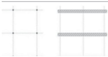
تصویر شماره ۶۴: مقایسه سیستم سازه‌ای دیوار باربر و شبکه‌ای
