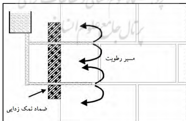
شکل ۲- تزریق آب و استخراج نمک با ضمادگذاری یا روش فشرده‌سازی تزریق [۲] (Grassegger et al, 2003)
