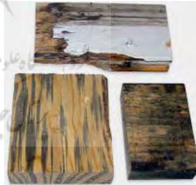
تصویر ۹- انواع تأثیرات قارچ ها در چوب. پوسیدگی در بالا، باختگی در چپ و کپک در راست
