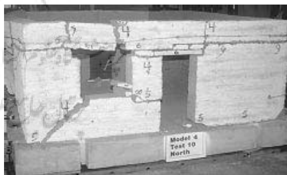
شکل ۵: بررسی رفتار سازه در مقیاس ماکت
