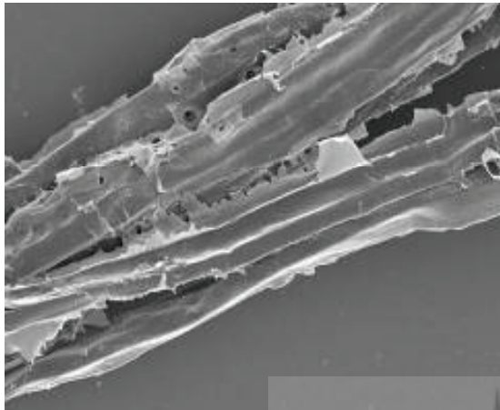
تصاویر ۲ و ۳ - تاثیر رزین در سطح چوب و سطح خارجی الیاف
