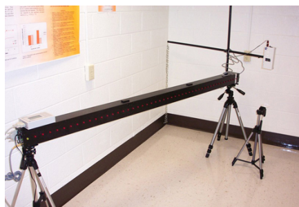
شکل ۱. دستگاه پیش‌بینی انطباقی باسین مدل ۳۵۵۷۵ ساخت شرکت Lafayette Instrument
