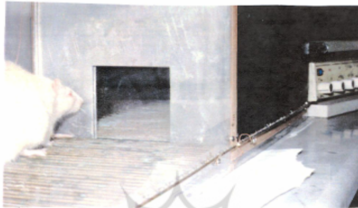
شکل (۱) تصویر رت نر در قسمت روشن دستگاه شاتل باکس (درب گیوتینی حداقل اتاق روشن و تاریک و نیز پیچ‌های کنترل مربوط به تنظیم شدت جریان و مدت زمان ارائه شوک در تصویر مشخص است)
