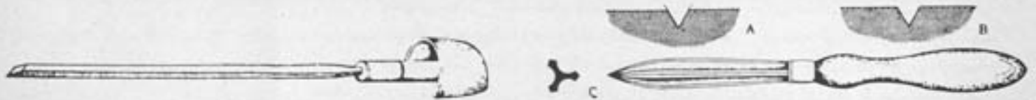
طرحی از یک قلم حکاکی و نمونه‌ای از یک نوع Scraper و منقطع آن
