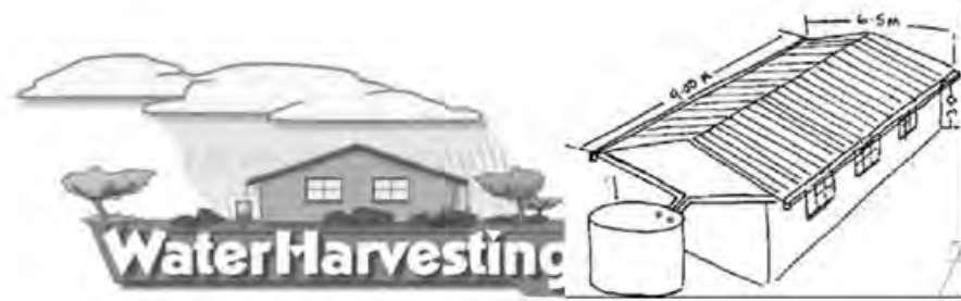
شکل ۲ نمایی ساده از جمع‌آوری آب از سطوح عایق آماده (پشت بام منازل، کارخانجات و...).
