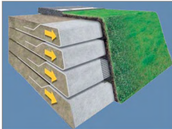
شکل ۳- استفاده از ژئوتکستایل در دیوار حائل
