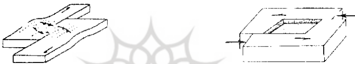
شکل ۳: حوضه برشی و نحوه عملکرد نیروها بر روی آن (مابال ۱ ، ۱۹۹۰: ۵۵۲)
