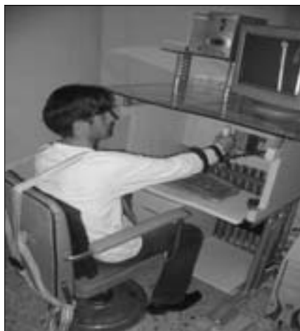
شکل ۱. دستگاه ثبت و تحلیل حرکات دوتعدی دست انسان در محیط نمایش مجازی و نحوه ی عمل آزمودنی ها.
