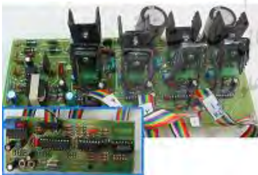
شکل ۱۲: درایور موتور سوئیچ رلوکتانس
