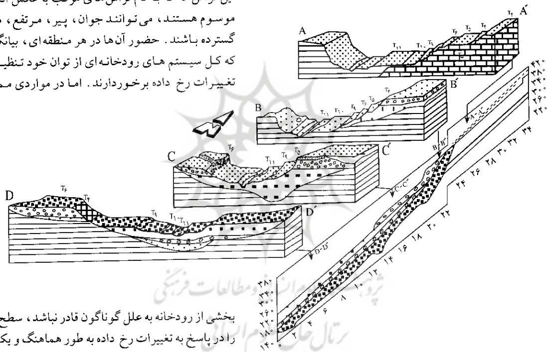
شکل ۴. تفاوت در آرایش تراس ها در بالادست و پایین دست رودخانه (بنیتو و همکاران، ۲۰۰۰، ص ۲۱۹)
